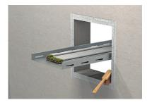
2. Kabel, Schottbereich und je Seite 150 mm vorm Schott mit FLAMRO® BML beschichten.
