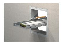
3. Mineralfaserplatten zuschneiden, umlaufende Randflächen mit FLAMRO® BMS einstreichen. Öffnungen in zwei Lagen verschließen.
