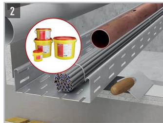
Die durchgeführten Kabel, Leitungen, Bündelrohre und Kabeltragekonstruktionen müssen zu beiden Seiten mit der Ablationsbeschichtung „FLAMRO BMA“ beschichtet werden. Die Trockenschichtdicke muss min. 2 mm betragen.
