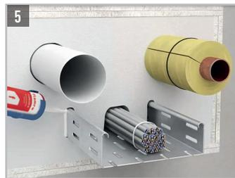
Die Beschichtungsdicke muss min. 1 mm betragen. Der Zwischenraum zwischen den beiden Brandschutzplatten braucht nicht beschichtet zu werden. Verbleibende Öffnungen dürfen mit loser Mineralwolle fest ausgestopft werden. Kabelbündel bis 100 mm müssen im Innern nicht mit Baustoffen ausgefüllt werden.
